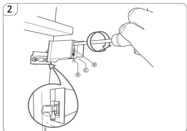
Marker plasseringen av hver av veggbrakettene, slik at de vil være plassert inntil sideveggene i enheten. Høyden på braketten avhenger av hvilken totalhøyde du vil gi møbelet. Marker hvor veggbrakettene skal sitte, og lag 2 hull for hver veggbrakett. Fest brakettene.
