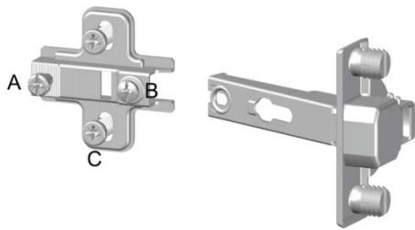
Fjerne dør (skrue A): Løsne skrue **A** inntil døren kan løftes bort fra hengselet.
