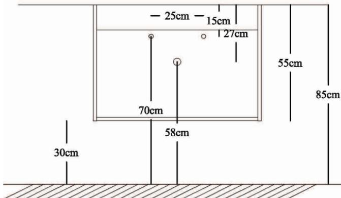
Når møbelet er montert settes servanten på plass ved hjelp av et silikonpunkt på hvert hjørne av møbelet. Deretter forsegles gapet mellom servant og møbel, samt gapet mellom servant og vegg med silikon. Dette gjøres for å unngå at det kommer vann på innsiden av skapet.
